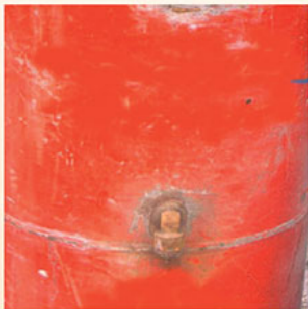
جوشکاری غیر مجاز بر روی بدنه کپسول
