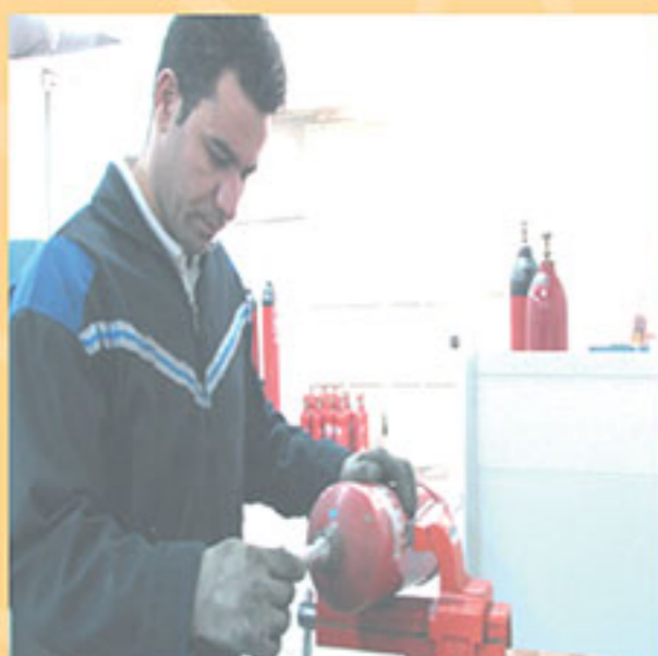
آزمون تست هیدرواستاتیک به روش انبساط حجمی
