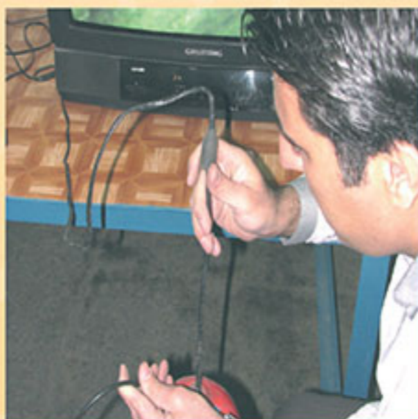
بازرسی چشمی داخل کپسول با ویدئواسکوپ
