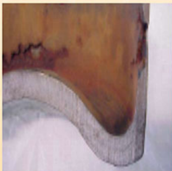
خوردگی حفره های داخلی بایه کپسول CO 2
