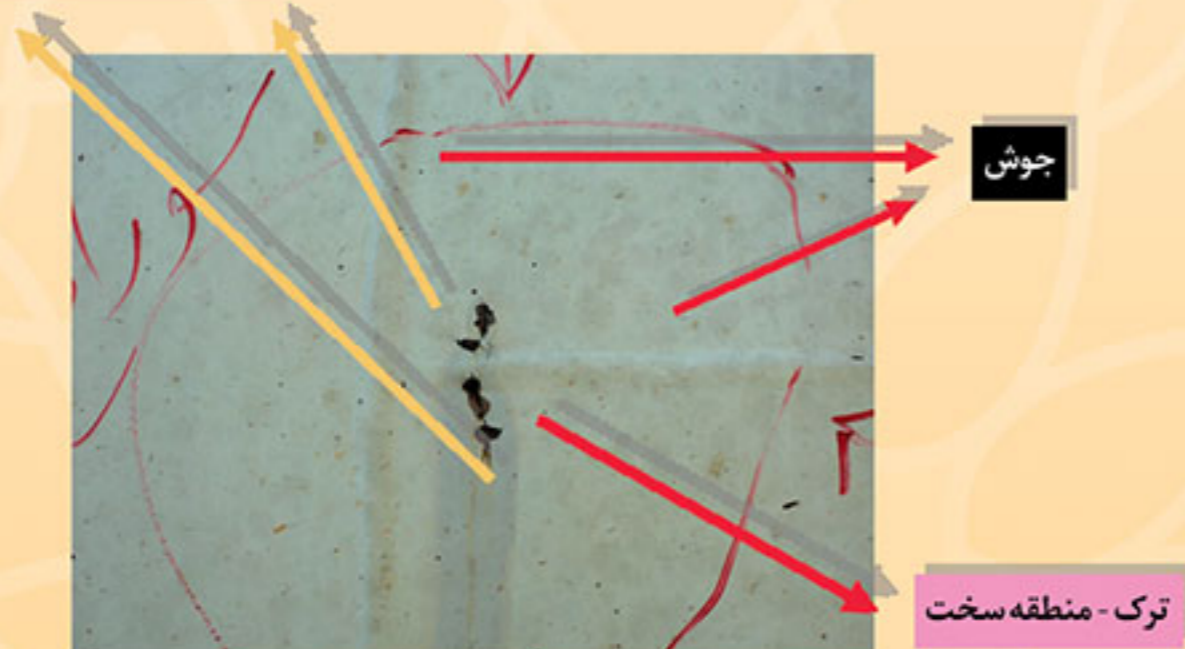
ترک در محل اتصال جوش کلگی مخزن به بدنه
