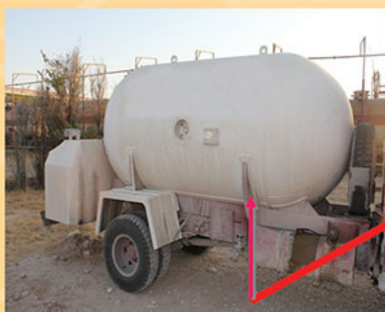
ترک در محل اتصال جوش کلگی مخزن به بدنه
