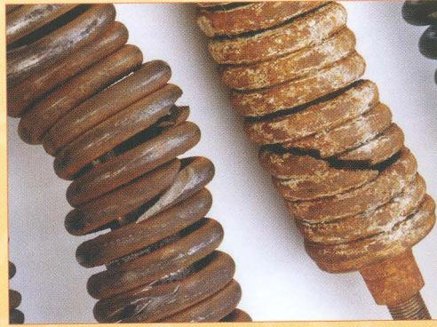
آثار شکست روی رهانه اطمینان مخازن گاز مایع ناشی از ناخالصی هیدروژن سولفور
